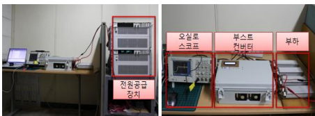
그림 3 부스트 컨버터 동작실험 Fig. 3 Experiments of the boost converter
