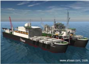
Allsea사 Pieter Schelte (대우조선해양에서 건조중) 리프팅 용량: 48,000톤(Topside), 25,000톤(Jacket) catamaran type으로 세계 최고 용량 보유 예정
