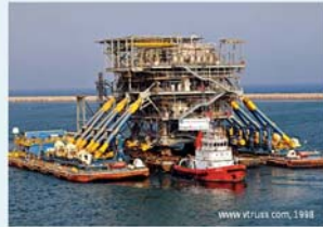
Versatruss Americas사 Versatruss 리프팅 용량: 6,100톤 실적보유 (~25,000톤 가능) 두대의 바지선과 트러스 구조를 이용하여 리프팅
