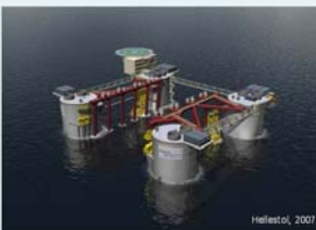
Keppel Verolme사 MPV Heavy Lifter ☞ 리프팅 용량 : 20,000톤 ☞ 4개의 콘크리트 밸러스트 적용
