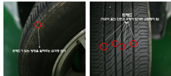
그림 3. 타이어 마모도 확인을 위한 타이어 표시가 되어 있는 부분
