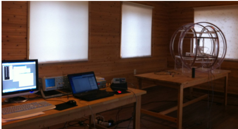
그림 2. 비자성 실험실에서 3-축 Helmholtz코일을 사용하여 magnetometer의 특성을 측정하는 사진.
