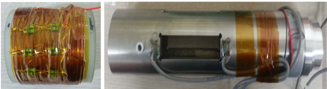
그림 2. 탄속 정보를 입력하기 위한 transmitter coil; (a) 조립 전, (b) 조립 후
