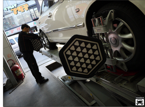
그림 4. 휠 얼라인먼트 장비로 편마모 측정 방법
