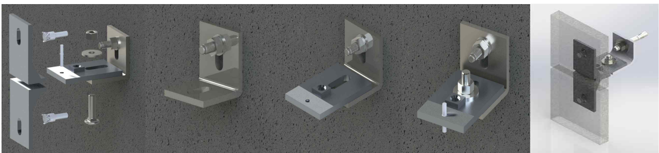
그림 1. 개선된 석재 외장재 공법의 구성 및 설치과정
