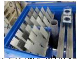
그림 3. CASS 시험에 의한 부식 촉진 광경
