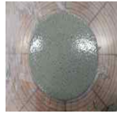
그림 1. 테이블 플로 시험
