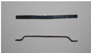
그림 1. Amorphous steel fiber and conventional steel fiber
