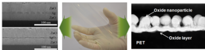
그림. 1. 2차원 및 3차원 나노구조체를 이용한 유연투명전극
