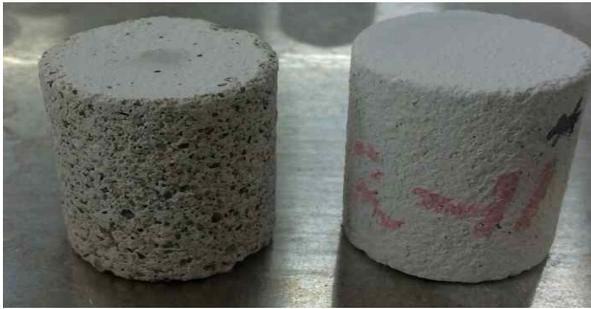
그림 1. 일반 세골재와 고로슬래그 세골재(BFSS)로 치환한 시료의 표면(3% 황산수용액, 20일경과)
