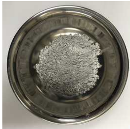
그림 1. 붕규산유리 미분말(평균입경 13 \mu m)
