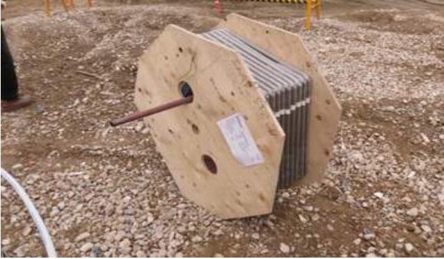
사진 1. 50 cm 길이로 센서가 매립된 SAA 모습
