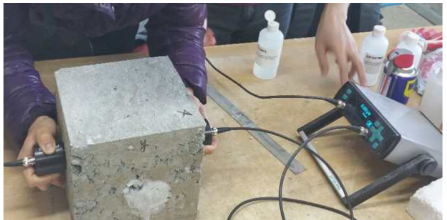
사진 2. 양생된 시편에서 초음파 속도를 측정하는 모습
