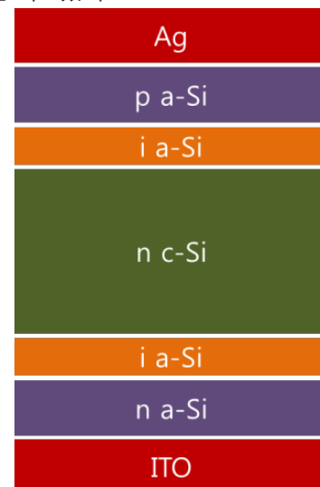
Figure 23. HIT 태양전지의 구조
