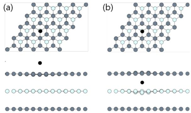
Fig. 3. 검은색은 Ne 원자를 나타낸다. (a) Hollow site에 Ne 원자를 1개 adsorption시켰을 때 안정화된 구조. (b) Hollow A site에 Ne 원자를 1개 intercalation시켰을 때 안정화된 구조.
