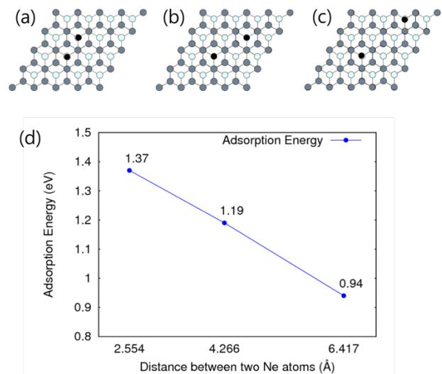
Fig. 4. (a) 2.554Å 거리만큼 떨어진 위치에 Ne 원자 2개를 adsorption시켰을 때 안정화된 구조. (b) 4.419Å 거리만큼 떨어진 위치에 Ne 원자 2개를 adsorption시켰을 때 안정화된 구조. (c) 6.417Å 거리만큼 떨어진 위치에 Ne 원자 2개를 adsorption시켰을 때 안정화된 구조. (d) (a)-(c)에서의 각 거리에 해당되는 adsorption energy.
