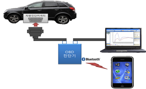
그림 1. OBD-II 및 블루투스 네트워크를 이용한 자동차 진단 개략도
