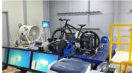
그림 2. 디지털전동변속기 내구성 시험
