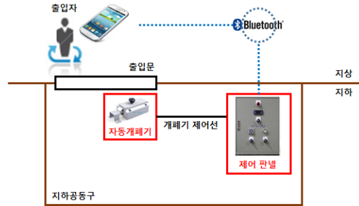
그림 2. 자동개폐기 및 제어 판넬 구성도
