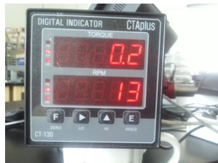
그림 8. 토크/RPM 센서(130)의 실험 결과
