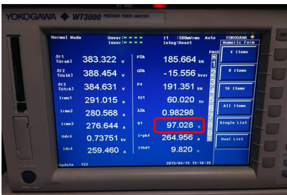
그림 4 ESS모드시 전력측정 결과
