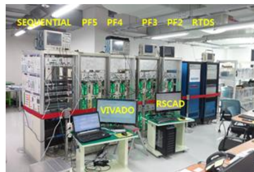
그림 2 실시간 제어 Hardware 검증장비 사진 Fig. 2 Photograph of Test bed for Real Time Control Hardware
