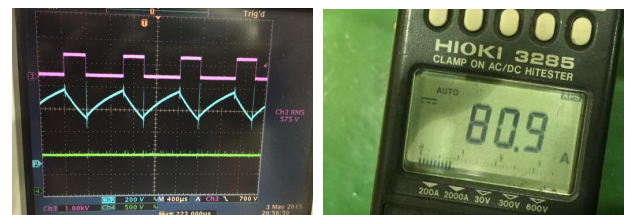
(a) 측정 파형-ch3: 출력 전압 (b) 출력 전류 측정 그림 4. 충전 시 시험 파형 및 사진
