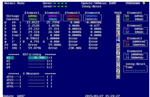
그림 4 실험 결과 (효율측정) Fig. 4 Experimental result (Efficiency measure)
