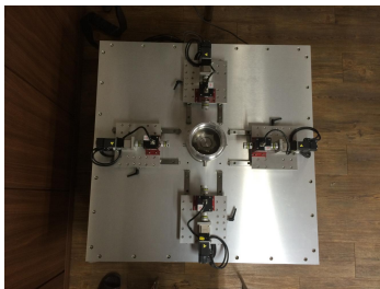
그림 4 공력 부하 구현 장치 Fig. 4 Apparatus for aero dynamic torque production
