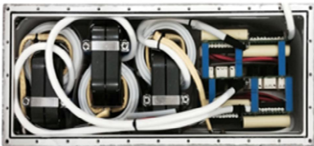
그림 3. 고전압 변압기 및 정류부 제작 사진 Fig. 3. Picture of developed high voltage transformer and rectifier
