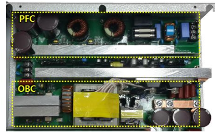
그림 4 탑재형 충전기 제작품 Fig. 4 Circuit of the PSFB-type on-board charger.
