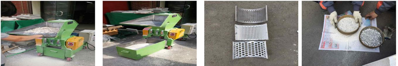
그림 4. 실험과정 및 커터 밀 사용 (내부)스크린
