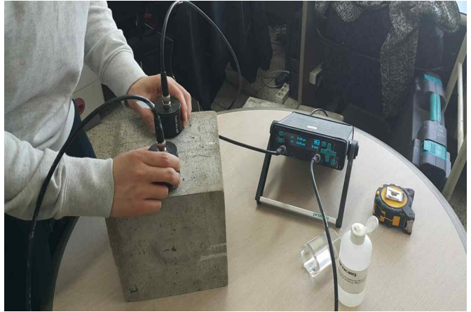
사진 1. 시편 균열 깊이 측정 모습
