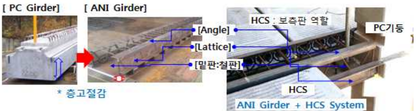
그림 1. ANI Girder의 구성 및 역할
