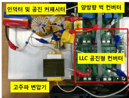
그림 3. 8.5kW 절연형 배터리 충방전기 시작품
