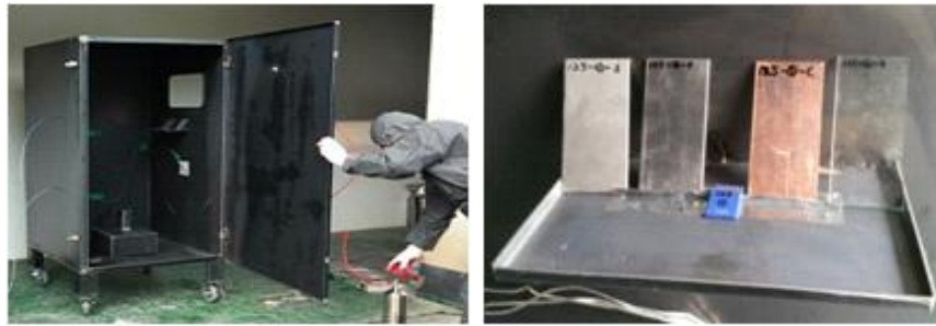
(a) 시험 전경 (b) 금속 및 비철금속 등의 시편 그림 2 시험 전경 및 부식성 측정용 시편
