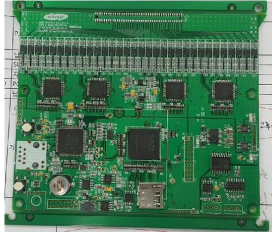
그림 7. 개발된 통합 Digital Signal Processing Board
