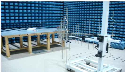
그림 5. 1 GHz 이하 측정 셋업, (Center of Harness 위치)
