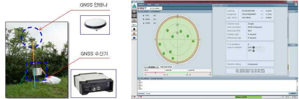
< GNSS 장비 설치 >
