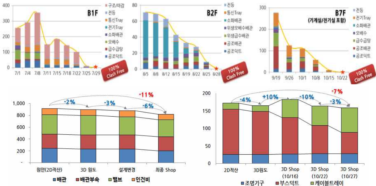
그림 2. 간섭해결 모니터링 결과(위) 및 공종별 원가절감 결과(아래)
