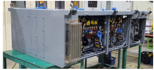
그림 5 공진형 컨버터를 적용한 철도차량용 SIV Fig. 5 SIV for Railway vehicle adapted LLC resonant converter
