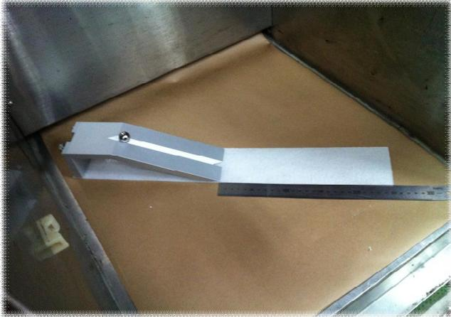
그림 1. 온도별 Tack Rolling Ball 시험편
