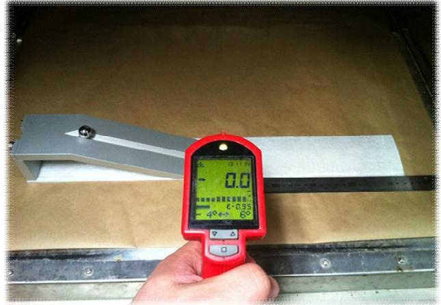
그림 2. 온도별 Tack Rolling Ball 시험 현황
