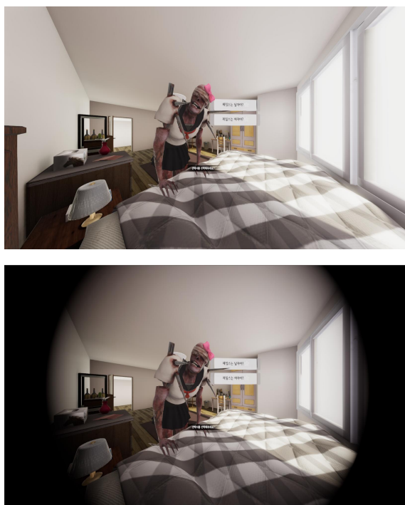
Fig. 2. Vignet 효과를 이용한 FOV 축소
