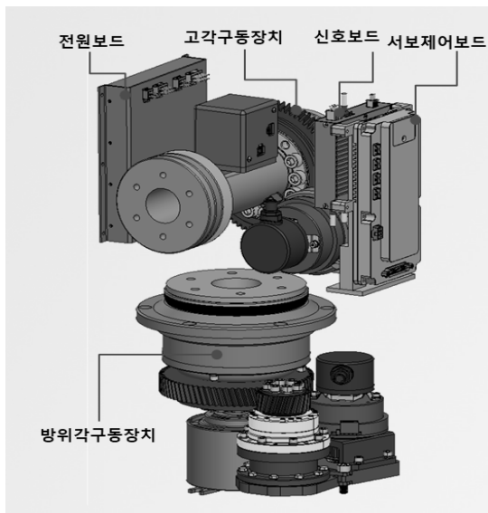
Fig. 4. 서보구동장치 설계 개선 후 내부 형상
