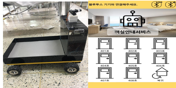
Fig. 4. Bellboy Robot using LiDAR
