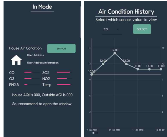
그림 4. 어플리케이션 실내 대기 질 데이터 모니터링 화면과 센서별 평균 데이터 그래프
