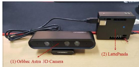
그림 1. IoT 기반 3D 카메라 모듈 구성
