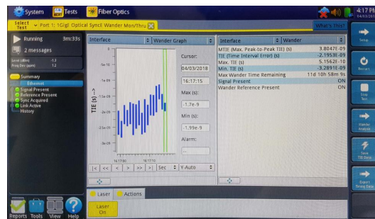
그림 4 Sync-E Wander generation 측정결과 1
