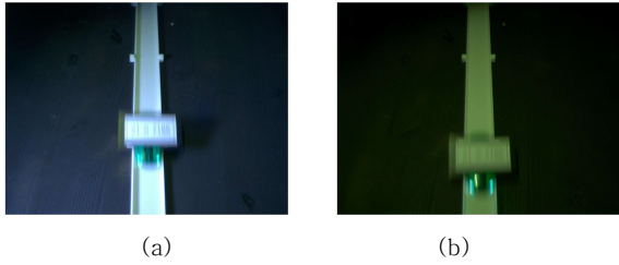
그림 1. 외부조명 및 주변광 조건에서 획득한 모션블러 영상. (a) 고속으로 동작하는 외부조명을 사용해 획득한 모션 블러 영상 i_1(x) ; (b) 주변광이 있는 조건에서 획득한 영상 i_2(x) .
