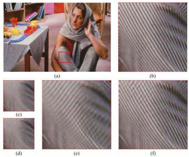
그림 4 기존 연구[2]의 복원 영상. (a) 원본 영상. (b) 원본 영상 확대. (c) 영상(b)를 bicubic interpolation한 영상. (d) 영상(b)를 CNN-CR로 다운샘플링한 영상. (e) (c)를 딥러닝으로 복원한 영상. (f) (d)를 딥러닝으로 복원한 영상
