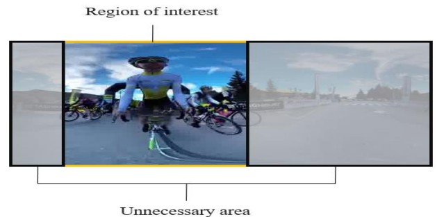
그림 1 제안하는 관심 영역 추출을 이용한 행동 인식 전처리 기법
