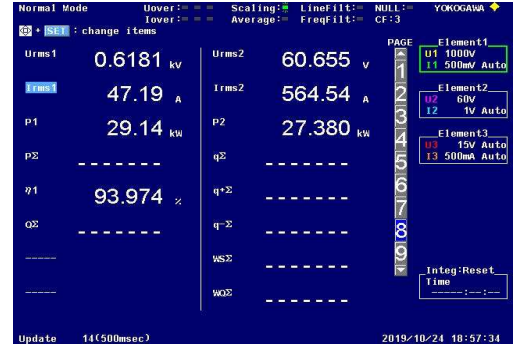
그림 8 용접전원 DC Stack 효율 데이터 @30kW
