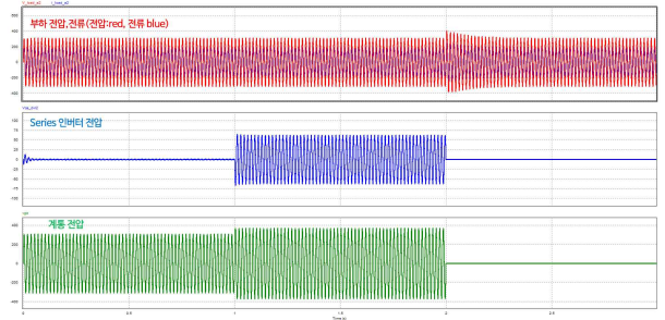
그림 4 과전압 시의 시뮬레이션. (위: 부하 전압, 전류 중간: Series 인버터 전압, 아래: 계통 전압).
